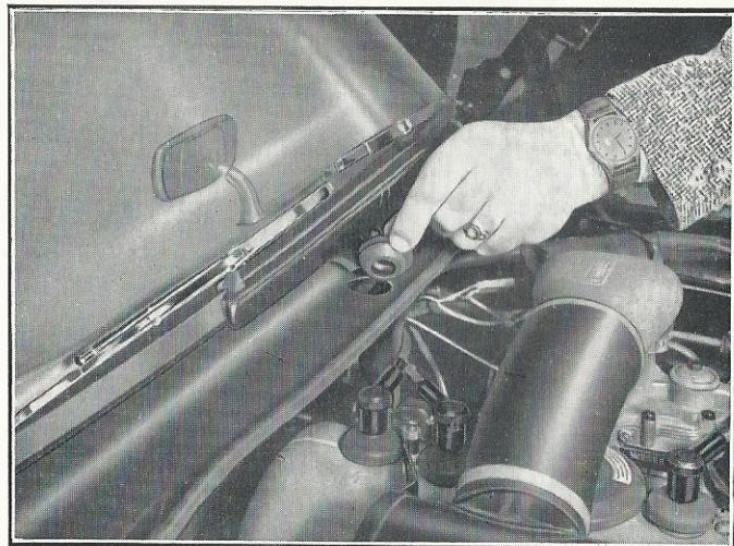
25 Fig. 25. Afmontering af det 4. tændrør.
