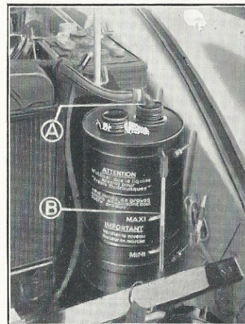
4 Fig. 4. A — Filter for trykvædske. B — Kontrolglas.
