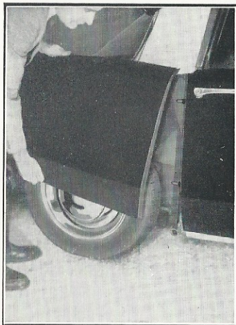
14 Fig. 14. Afmontering af en bagskærm.
